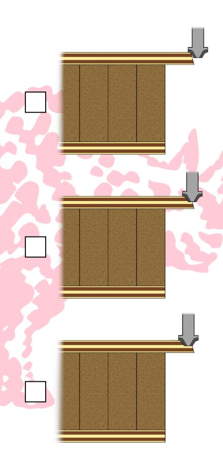
Bei Türen mit Lichtausschnitten in Verbindung mit Oberflächenkannelierungen ist es notwendig, dass Sie uns eine genaue Angabe zukommen lassen, wie die Trapeznut in den Lichtausschnitt einlaufen soll.
